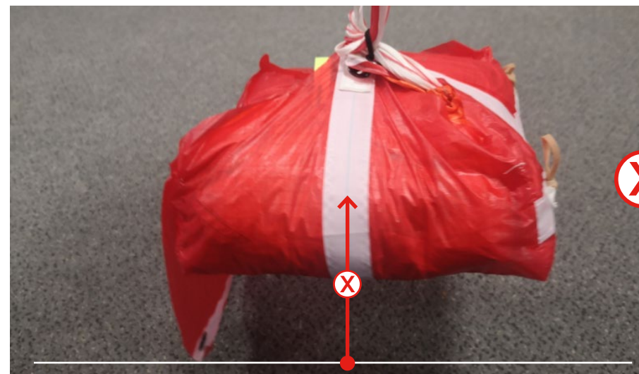
Faux : Le parachute, plié dans le sac de déploiement, peut être soulevé par la bride.
